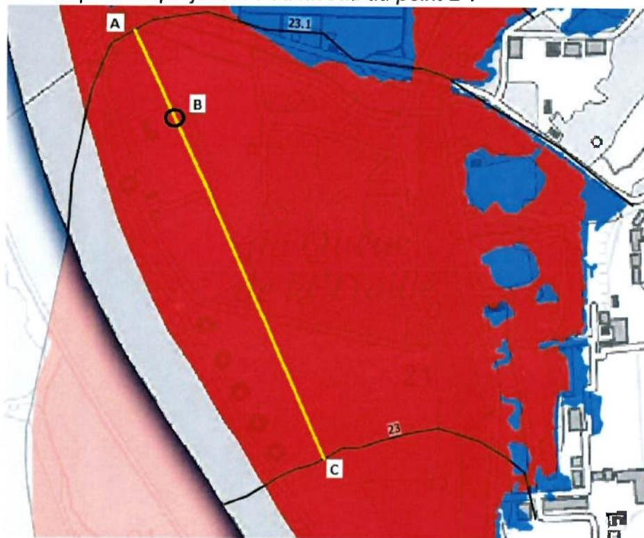
$$\text{Cote de référence au point B} = \frac{\text{Distance AB}}{\text{Distance AC}} \times (\text{Cote au point C} - \text{Cote au point A}) + \text{Cote au point A}$$
